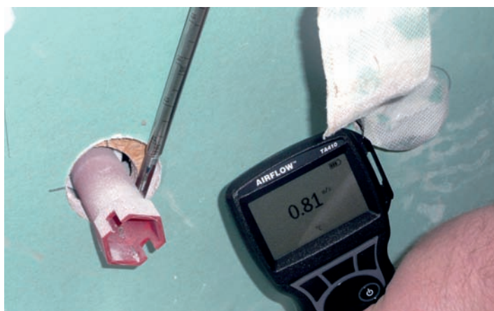
Obdobná situácia ako na obrázku vľavo, tentokrát však pri vodoinštalácii. Riešením v oboch prípadoch je použitie gumových tesniacich prechodiek.
